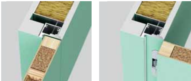
Bezprzylgowe standard (otwierane na zewnątrz) - drzwi prawe
